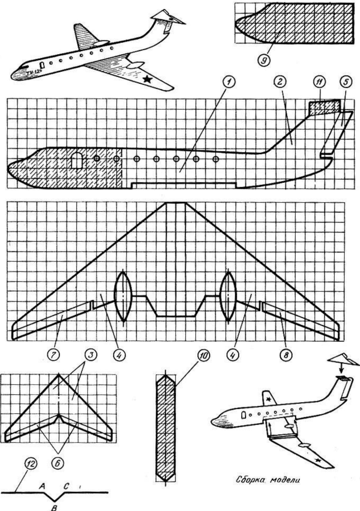
Рис. 10. Модель самолета Ту-34: 1 - фюзеляж; 2 - киль; 3 - стабилизаторы; 4 - крылья; 5 - руль поворота; 6 - руль высоты; 7 - элерон левый; 8 - элерон правый; 9 - груз из картона; 10 - дополнительная деталь; 11 - клапан для клея; 12 - схема изгиба крыльев
