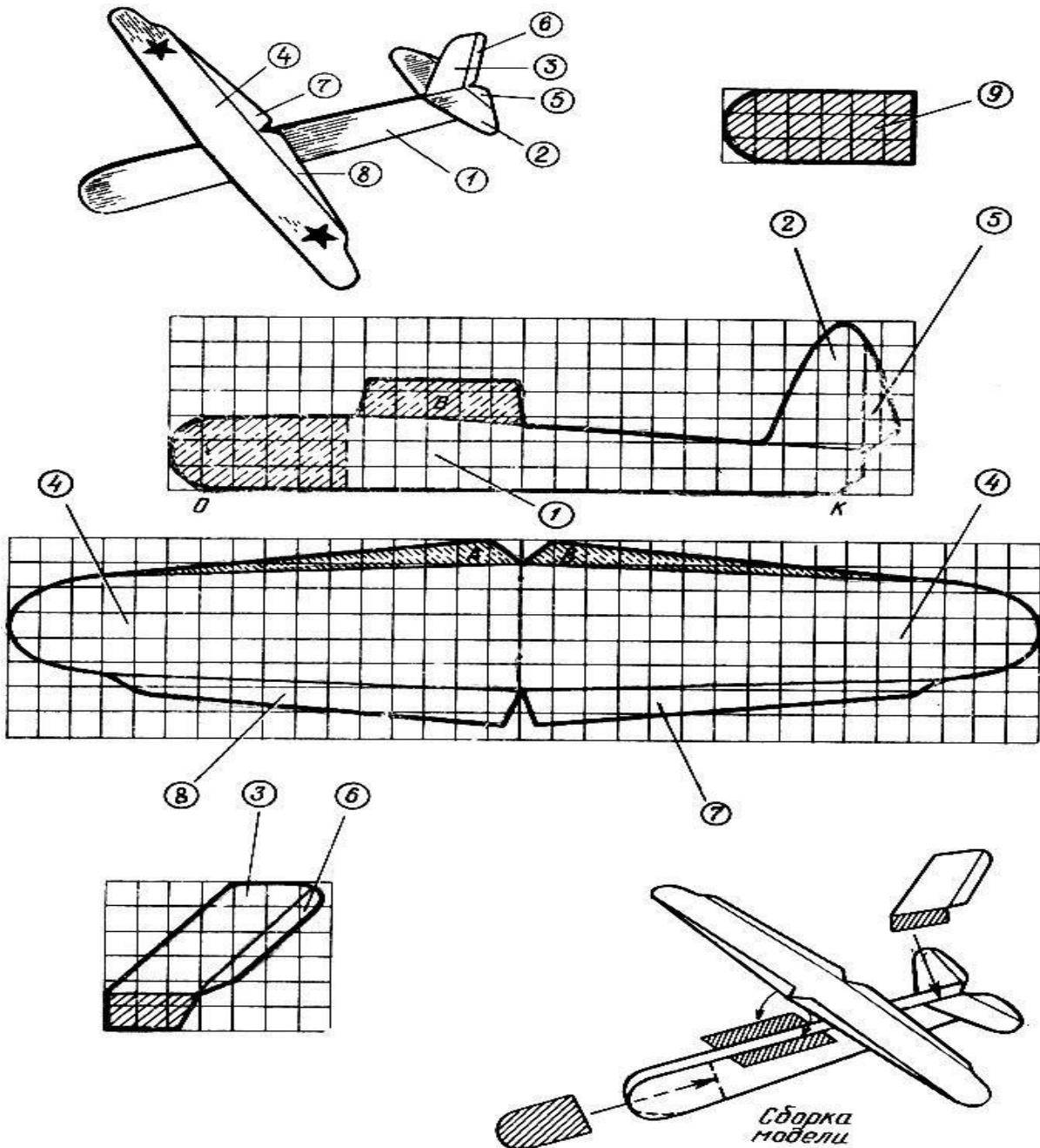
крылу. Крылья (4) устанавливают симметрично на отогнутые клапаны (В) и приклеивают. Модель необходимо отцентровать, замаркировать, и планер готов.
