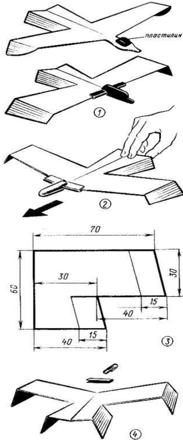
Рис. 5. Модель планера-птицелета с машущими крыльями
