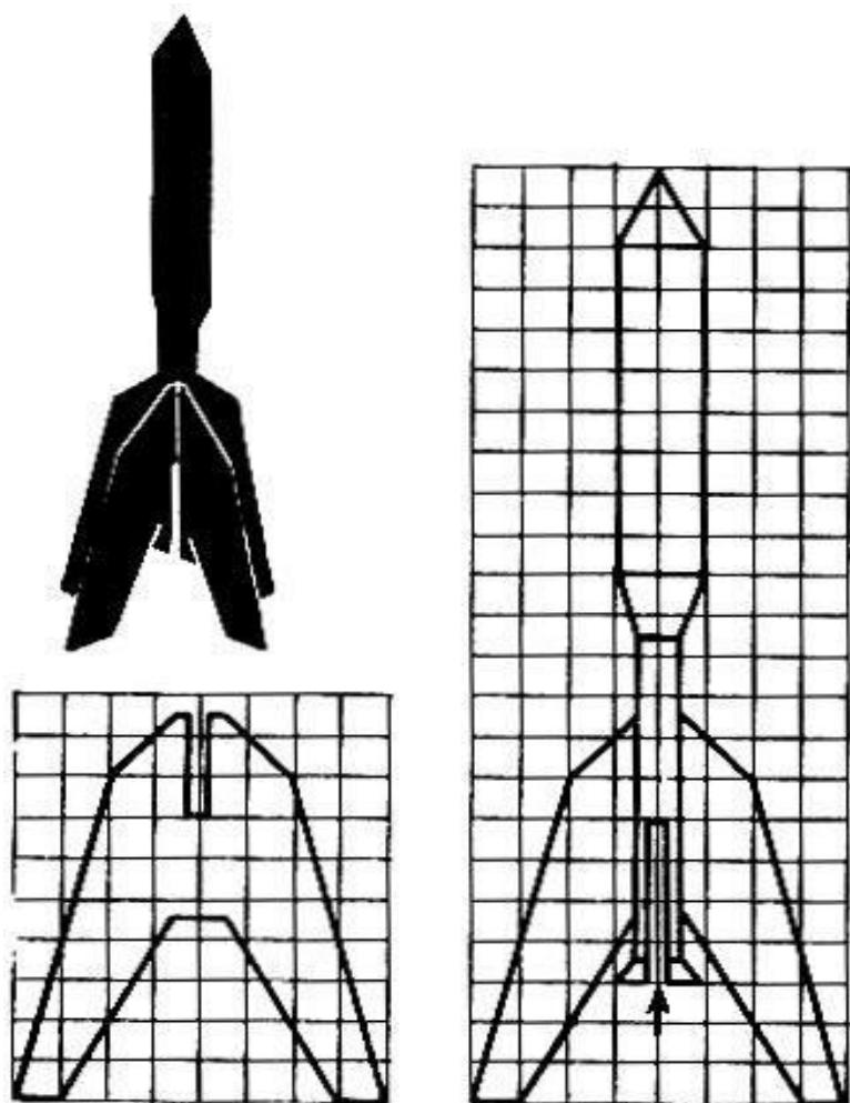
Рис. 3. Макет ракеты с поперечным шарниром
