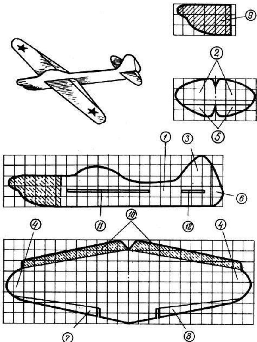
Рис. 9. Модель самолета Як-3: 1 - фюзеляж; 2 - стабилизаторы; 3 - киль; 4 - крылья; 5 - руль высоты; 6 - руль поворота; 7 - левый элерон; 8 - правый элерон; 9 - груз из картона; 10 - клапаны, образующие переднюю кромку крыла (при подклейвании); 11 - прорезь для крыльев; 12 - прорезь для стабилизатора
